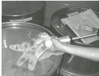
図2.6 検知管を用いた簡易的な透過確認
